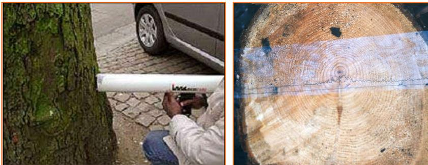
costante dell'ago, parametro che va adattato alle specifiche caratteristiche di densità del legno da esaminare: 50 mm/min per legni ad altissima densità e 700 mm/min per legni molto teneri. La resistenza alla penetrazione infatti può variare fra le specie ed anche fra alberi differenti appartenenti alla stessa specie.
